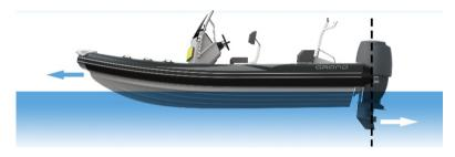
Fig. 22. Optimum trim/motor angle.
