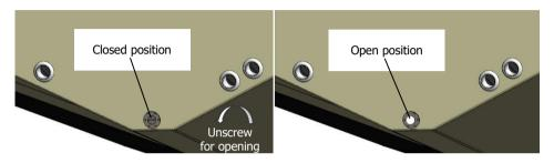
Fig. 4. Hull drain plug.
