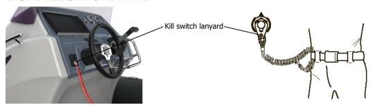
Fig. 26. Engine kill switch lanyard.
